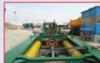
ساخت دستگاه لاینروچ ۳۰۰ تن جهت انجام عملیات Shore Pulling لوله گذاری در دریا به سفارش شرکت مهندسی و ساخت تأسیسات دریایی ایران
